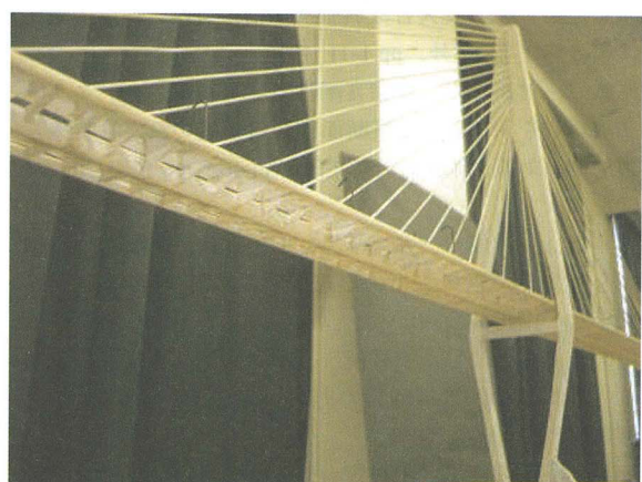
Photo.2 模型写真桁下
