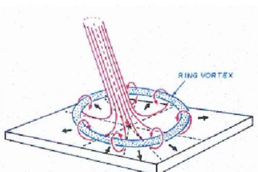
Fig. 10 Vortex-Ring model<sup>1)</sup>.
