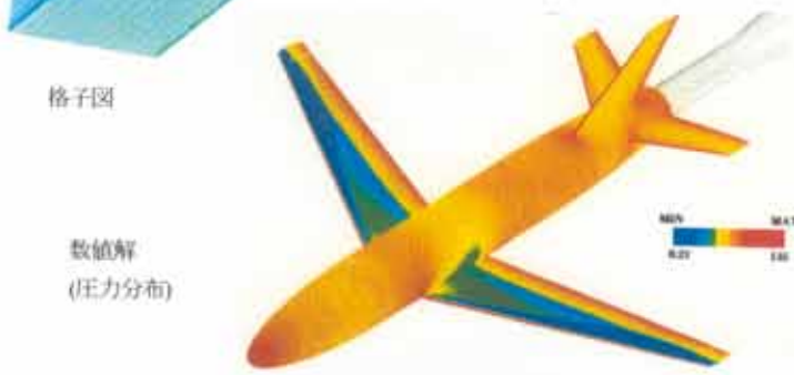
図 1. 遷音速風洞内航空機全機モデル流れの数値計算
