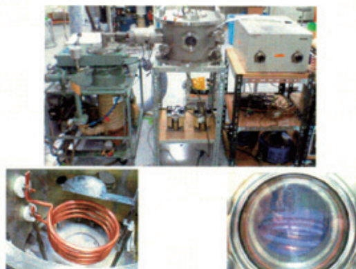
図 2 多目的プラズマ支援薄膜形成装置
