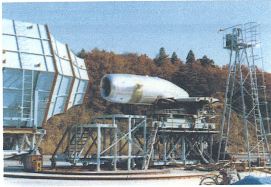
図2 USB方式高揚力システムの地上試験
